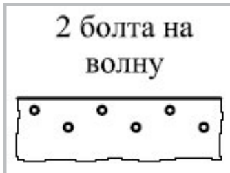
Стандартная схема двухболтового соединения
