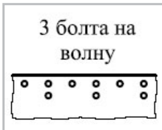
Схема трехболтового соединения
