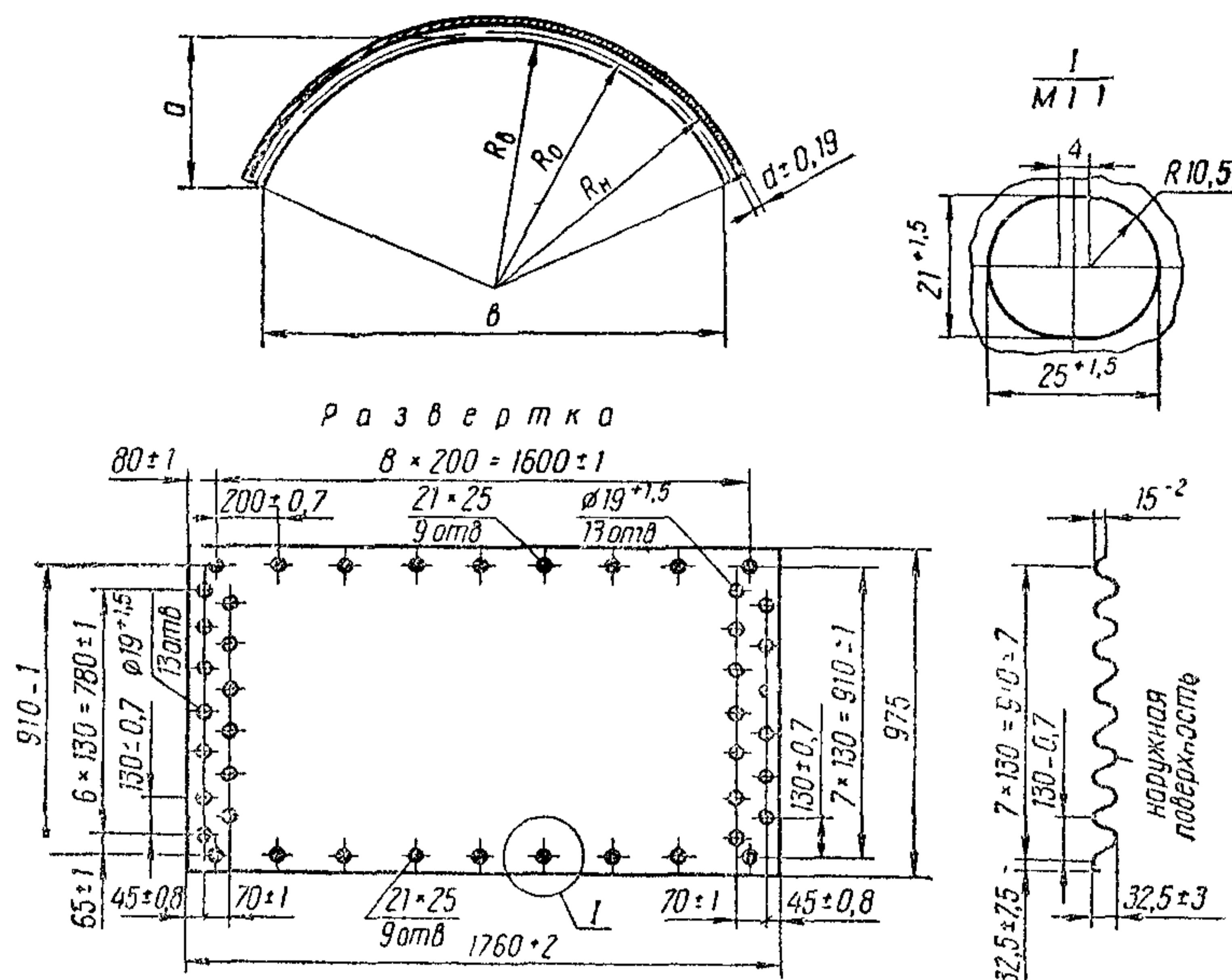
Рис. 2. Стандартный элемент труб ЛМГ
