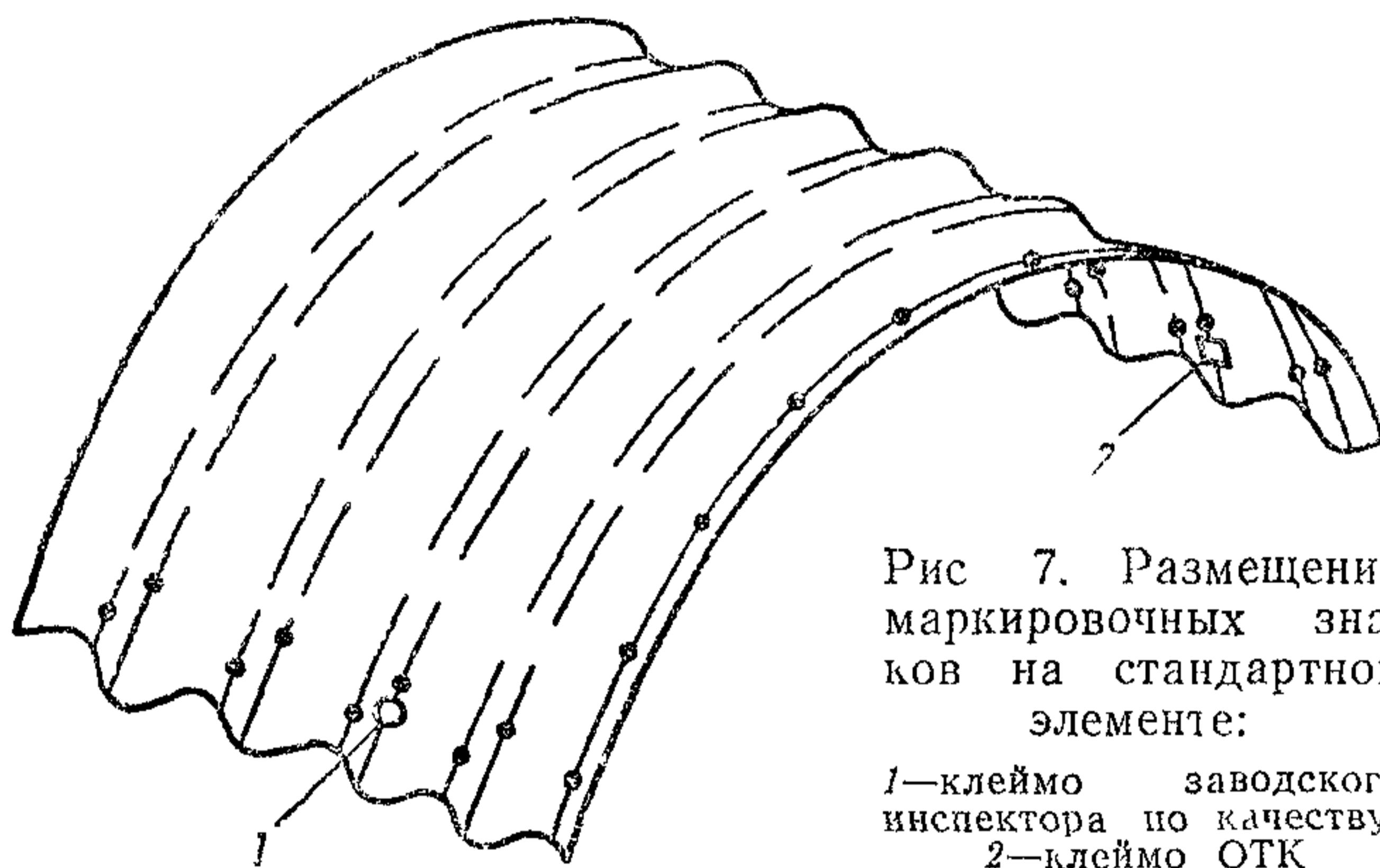
Рис. 7. Размещение маркировочных знаков на стандартном элементе:
