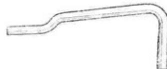
Фиг. 26. Скрепа для соединения секций труб диаметром от 46 до 92 см.
