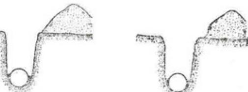
Фиг. 45. Схема расположения швов трубы после укладки до засыпки.
