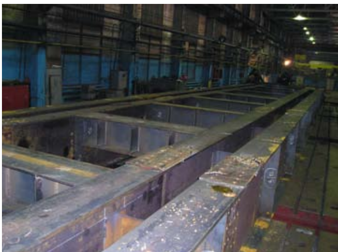
Мостовые конструкции для Коптевского путепровода
